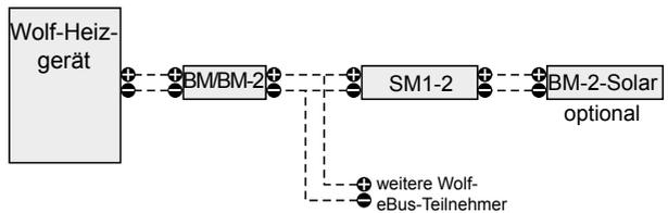
Falls der Solarspeicher einem anderen BM / BM-2 zugeordnet ist, ist die Bedienung auch von diesem BM / BM-2 möglich (vgl. Parameterbeschreibung *5QLD7*).
