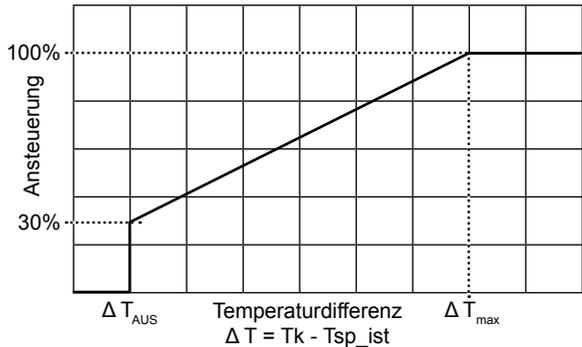
$\Delta T_{AUS}$  = Ausschalt-differenz Solarspeicher
