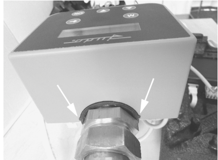
Abb. 10: Rückwand des Elektronikgehäuses einrasten
